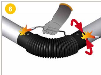
⚠ Les extrémités thermorétractables de la manchette accordéon du coude flexible doivent s'appuyer au minimum de 10cm sur la gaine PEHD du tube. Veillez à ce que les orifices d'injection ne soient pas obturés afin de pouvoir verser la mousse isolante et laisser l'air s'évacuer lors de son expansion
