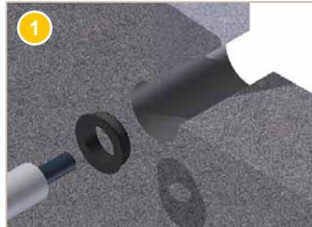
Percer un trou de réservation dans le mur d'un diamètre suffisant (voir page précédente).
