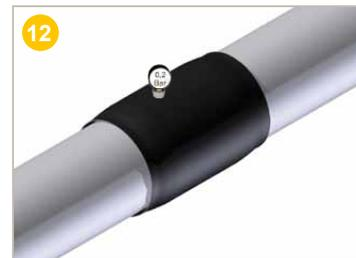
1) **Percer** un 1<sup>er</sup> trou dans la manchette à l'aide d'une perceuse en veillant à **ne pas percer sur la soudure de la coupe longitudinale**.
