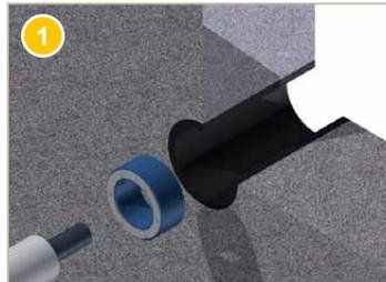
1) Percer un trou de réservation dans le mur conformément aux prescriptions indiquées dans la notice du produit. Le scellement d'un fourreau peut-être nécessaire afin d'offrir des surfaces planes.
