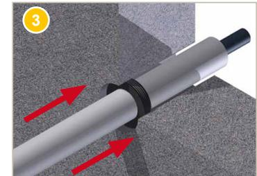
Faire **coulisser** le passage de cloison, si nécessaire ragréger le mur autour du passage de cloison afin d'éviter que l'humidité ne passe entre le mur et ce dernier.
