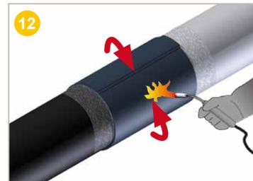
**Rétreindre** la bande thermorétractable sur sa circonférence par de larges mouvements en commençant par le centre. Selon le diamètre, utiliser un seul flambard pour un diamètre < ou égal à 450 mm et deux flambards pour un diamètre >450 mm. Si 2 torches sont utilisées, se positionner de part et d'autre du tube.
