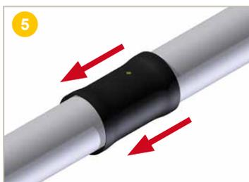
Faire **coulisser** la manchette thermorétractable au niveau de la zone dénudée de telle sorte qu'elle recouvre la gaine du tube de 5 à 10 cm de chaque extrémité. ▲ N'oubliez pas de retirer le film de protection et de vérifier la présence des bandes de mastic avant de rétreindre la manchette thermorétractable.
