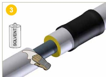
**Nettoyer et dégraisser** les surfaces rendues rugueuses à l'aide d'un chiffon trempé dans l'éthanol (min 94%).
