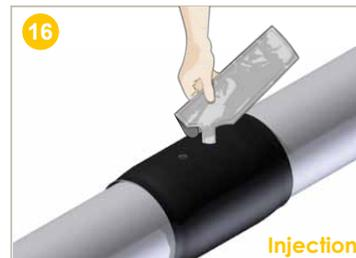
**Verser** le mélange dans l'un des trous d'injection de la manchette PEHD de diamètre 26 mm. Veiller à vider complètement la ou les poches
