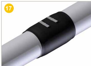
1) **Enfoncer** les 2 bouchons d'évents dans les 2 trous d'injection jusqu'à arriver en butée maximum.
