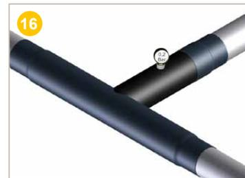
⚠ **Effectuer au minima un contrôle visuel de chaque manchon et dans l'idéal, compléter par un test d'étanchéité à l'air à 0.2 bar avec une pompe et un manomètre. Il est impératif de laisser refroidir à température ambiante avant de réaliser l'injection de la mousse polyuréthane.**
