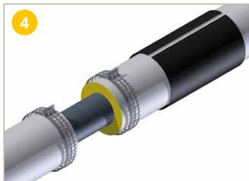
**Positionner** les grilles de fusion à l'aide du traçage préalablement réalisé et les **maintenir en position** à l'aide d'agrafes.
