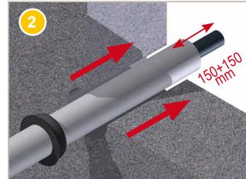
1) Positionner le passage de cloison en néoprène sur le tube.
