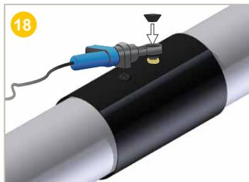
Répéter les opérations 15 à 17 avec le 2<sup>ème</sup> bouchon de fermeture à souder.
