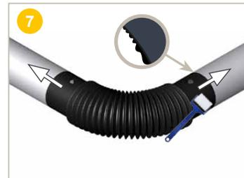
**Lisser** et **Evacuer** les bulles d'air à l'aide d'un rouleau. Après le rétreint et le retour à une température ambiante, vérifier la bonne adhérence manchette/gaine. Le rétreint est complet lorsque l'adhésif dépasse de chaque côté de la manchette.
