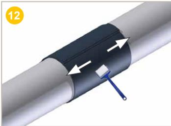
Quand la surface de la bande est encore chaude et malléable, utiliser le rouleau d'application pour **lisser** et **évacuer** les bulles d'air.
