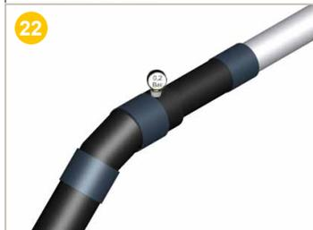
**⚠ Rappel :** Effectuer au minima un contrôle visuel de chaque manchon et dans l'idéal, compléter par un test d'étanchéité à l'air à 0,2 bar avec une pompe et un manomètre. Il est impératif de laisser refroidir à température ambiante avant de réaliser l'injection de la mousse polyuréthane.
