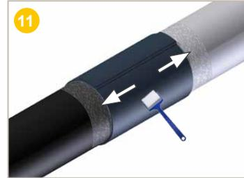
Quand la surface de la bande est encore chaude et malléable, utiliser le rouleau d'application pour **lisser et évacuer** les bulles d'air. Procéder de la même manière sur la fermeture.
