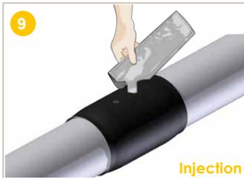
**Verser** le mélange dans l'un des trous d'injection de la manchette PEHD de diamètre 26 mm.
