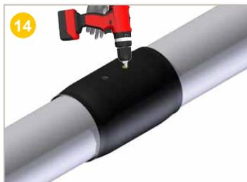
Une fois le test d'étanchéité à l'air réalisé et l'étanchéité de la jonction démontrée, **percer** le 2<sup>ème</sup> trou dans la manchette.
