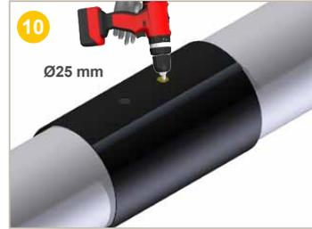
Une fois le test d'étanchéité à l'air réalisé et l'étanchéité de la jonction démontrée, **percer** le 2<sup>ème</sup> trou de 25 mm dans la manchette.
