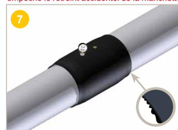
Laisser refroidir avant l'opération d'injection. Après le rétreint et le retour à une température ambiante, vérifier la bonne adhérence manchette/gaine.
