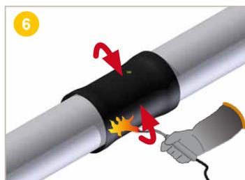
**Rétreindre** les extrémités de la manchette thermorétractable à l'aide d'un flambeur. Utiliser un seul flambeur pour les Ø ≤ ou égal à 450 mm et 2 flambeurs pour les Ø > 450 mm. Si 2 torches sont utilisées, se positionner de part et d'autre du tube.
