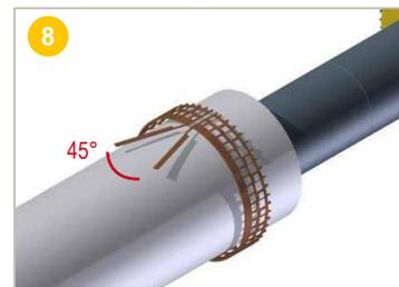
⚠ **Les extrémités des grilles de soudage ne doivent pas se toucher et être écartées d'environ 6 à 8mm.**
