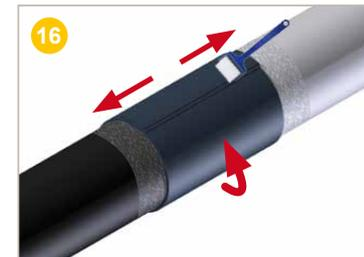
**Appuyer** fermement sur les deux extrémités de la bande thermorétractable.
