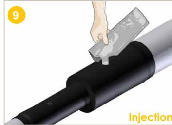
**Verser** le mélange dans l'un des trous d'injection de la manchette PEHD jusqu'à diamètre 26 mm.
