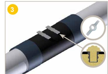
3) **Enfoncer** les 2 bouchons d'évents dans les 2 trous d'injection jusqu'à arriver en butée maximum.
