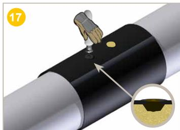
Positionner le bouchon de fermeture à souder dans le trou d'injection et appuyer doucement pendant environ 1 minute.
