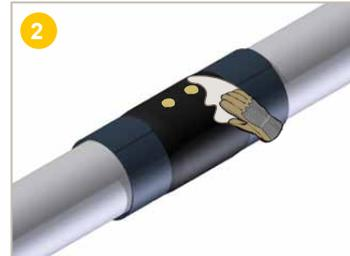
**Nettoyer** la surface pour enlever toute particule de polyéthylène ou de sable en utilisant un chiffon sec (ou le souffle de la flamme).
