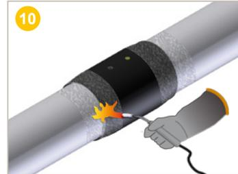
A l'aide d'un flambard, **préchauffer** les surfaces à recouvrir (*manchette + gaine 50 mm de chaque côté*) jusqu'à un minimum de **65°C**. **Contrôler** la température sur toutes les surfaces à l'aide d'un thermomètre.
