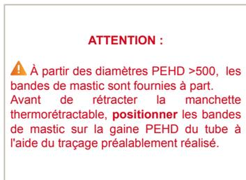
⚠ **À partir des diamètres PEHD >500, les bandes de mastic sont fournies à part. Avant de rétracter la manchette thermorétractable, positionner les bandes de mastic sur la gaine PEHD du tube à l'aide du traçage préalablement réalisé.**
